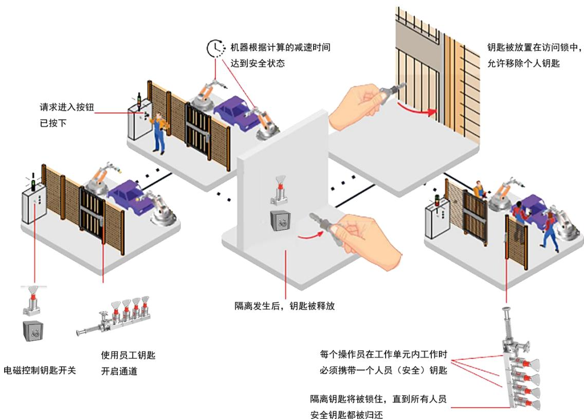
应用要求：工业混凝土搅拌机设有多个安全门，这些安全门通过机械联锁进行保护。这些安全门会在预定的清洁时间被打开。只有在搅拌机的电源被隔离并且机械固定后，才允许进入。
